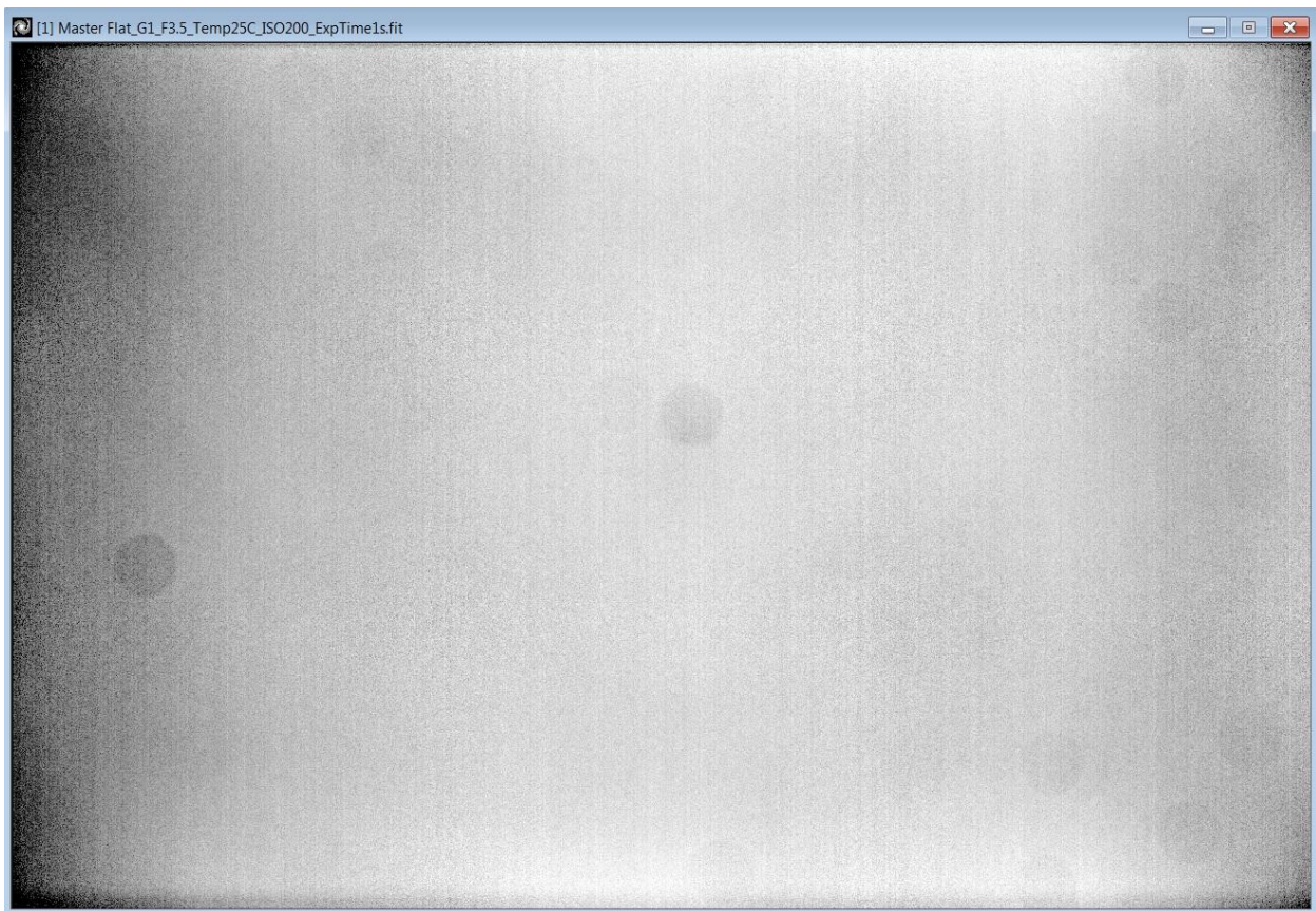
Figura 4.1. Imagen muy ampliada de una caja de luz con iluminación dispareja. (Imagen de Mark Blackford).
